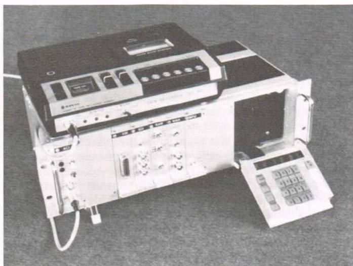
Bild 1 Am Institut für Elektronik der ETH in Zürich entwickeltes Mikroprozessorsystem mit dem Data-Recorder ZE 601 als Programmspeicher
