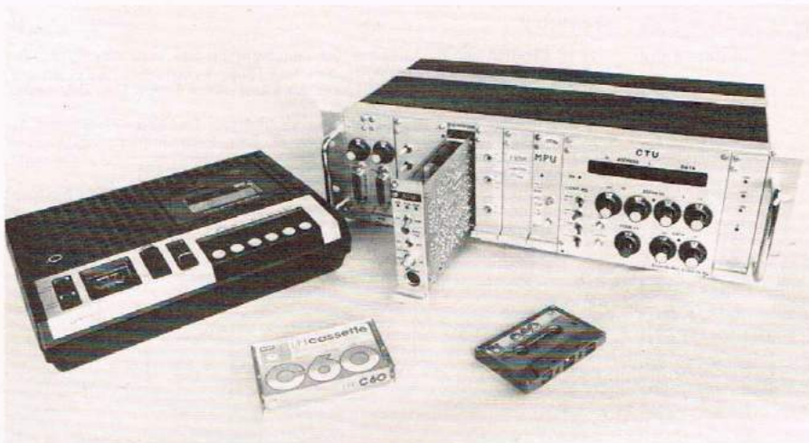
Bild 1.1 Das am Institut für Elektronik der ETHZ entwickelte Mikroprozessorsystem M 6800 mit dem Kassettenspeichergerät, Modem- und Interfaceein- schub herausgezogen.
