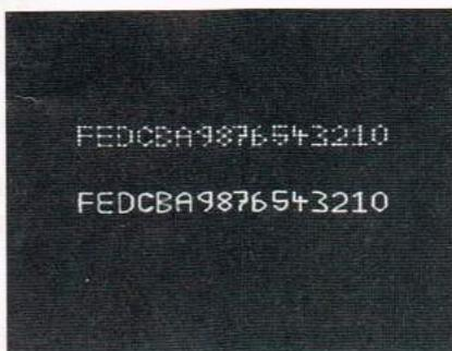
Bild 10. Darstellung der Sedezimalzeichen ohne Strahlaustastung bei rechteckförmigen (obere Zeile) und bei gefilterten Ausgangsspannungen (untere Zeile)
