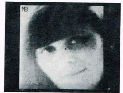
Bild 8. Darstellung von Schmalbandfernsehbildern mit dem Oszilloskopdisplay. Die projizierte Vorlage (Dia) wurde mit einer primitiven Anordnung (Fototransistor auf einem analogen x-y Schreiber montiert) zeilenförmig abgetastet und digitalisiert
