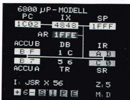
Bild 9. Darstellung des Funktionsablaufs eines Mikroprozessors auf dem Oszilloskopdisplay mit einem Software-Modell. Die Quadrate links unten dienen zur Steuerung mit einem Lichtgriffel
